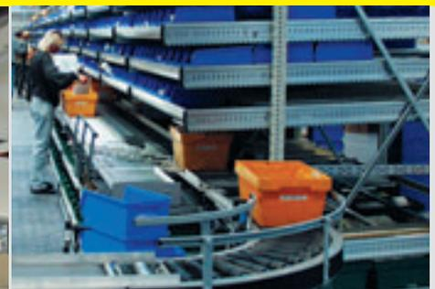
Bild oben: Kolli-Durchlaufregal mit integrierter Fördertechnik und Pick-by-light in der Verlagsbranche
