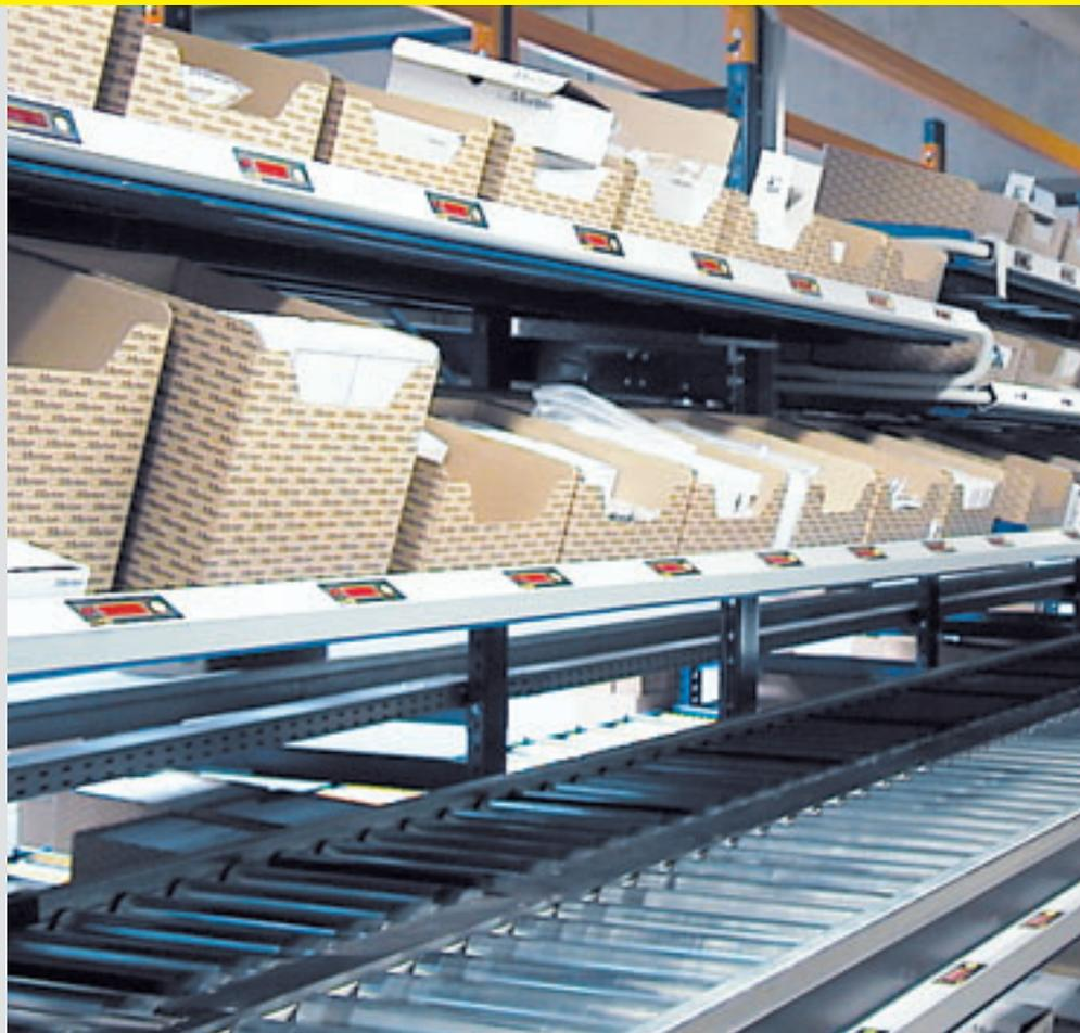
Bild unten: Das Pick-by-light verringert die Fehlerquote und erhöht die Zugriffsgeschwindigkeit in der Elektrobranche
